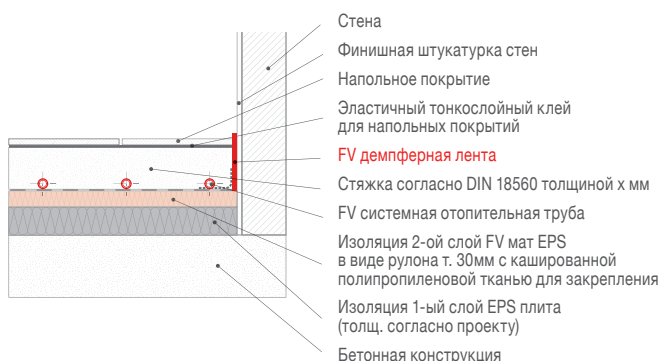
Рисунок 10: Укладка демпферной ленты FV
