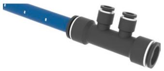
После осуществления монтажа соединенные детали можно провернуть, трубу можно вынуть, сжав соединительное кольцо. При повторном монтаже трубу следует снова смазать и проверить, не произошло ли повреждения.
