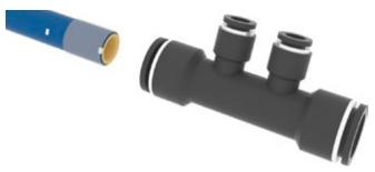
Фитинг надевается на трубу до упора. Труба 16 погружена на 27 мм, труба 8 - 20 мм. Можно ориентироваться по напечатанным на трубе обозначениям.
