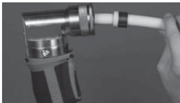
3. Вставьте расширитель в трубу и растяните. Поверните на 30° и растяните еще раз (используйте инструмент по диаметру трубы)
