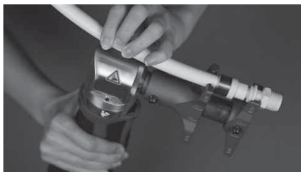
5. Прикрепите натяжные клещи к фитингу и гильзу натяните на фитинг
